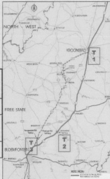
PROPOSED R30-TOL ROAD AND PROPOSED TOLL PLAZA LOCATIONS VOORGESTELDE R30-TOLWEG EN VOORGESTELDE TOLPLAZA LIGINGS
